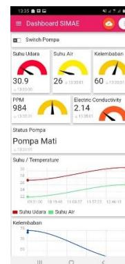
Gambar 2. Tampilan antarmuka pada aplikasi IoT MQTT Panel
